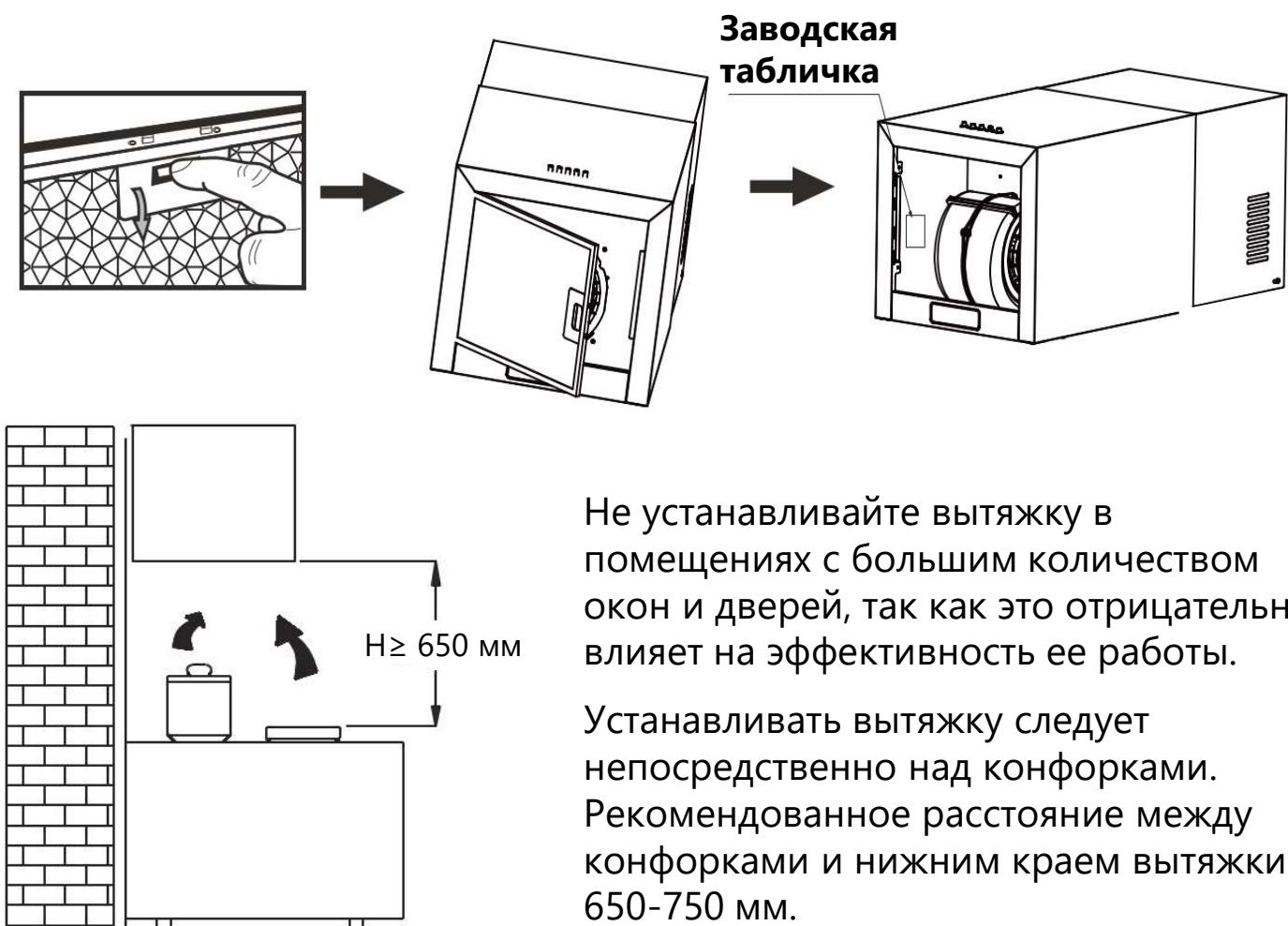
При наличии в комнате печи, газового котла или колонки необходимо учитывать, что во время работы вытяжка забирает из помещения воздух необходимый для горения, что особенно важно для помещений с герметичными окнами и дверями.
