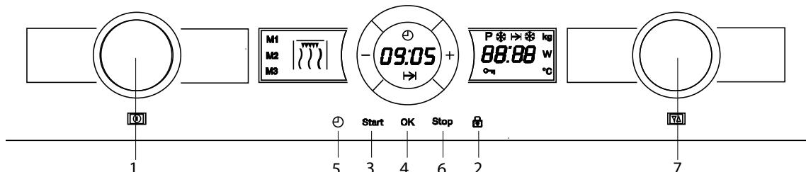
1. Поворачивайте **поворотный переключатель выбора функций** (1) до тех пор, пока не загорается индикатор функции **Микроволны + Гриль**. Дисплей отображения продолжительности цикла показывает мигающую индикацию 10:00.
