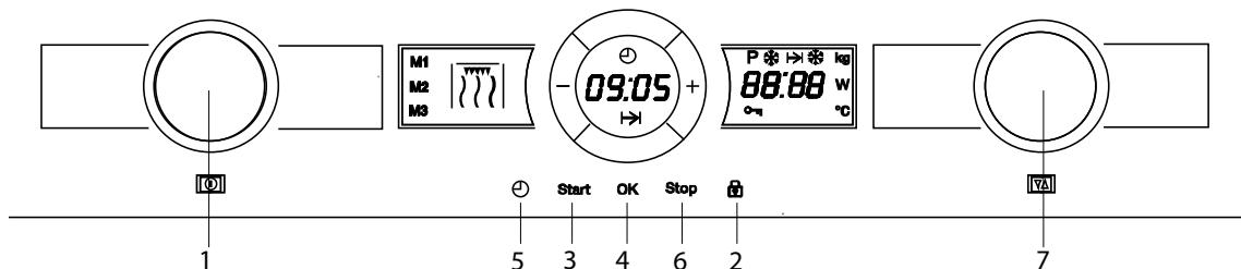
1. Поворачивайте **поворотный переключатель выбора функций** (1) до тех пор, пока не загорается индикатор функции Разморозка по времени. Дисплей отображения продолжительности цикла показывает мигающую индикацию 10:00.
