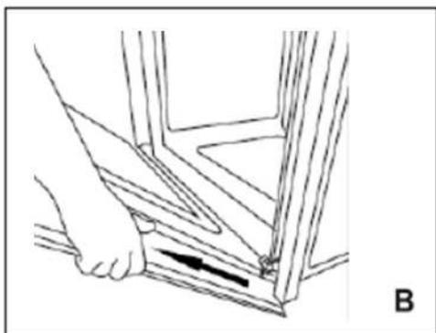
**В** Возьмите дверь обеими руками с двух сторон. Немного поднимите дверь и снимите петли с обеих позиций. Потяните дверь к себе, чтобы снять петли с отверстий рамки двери.
