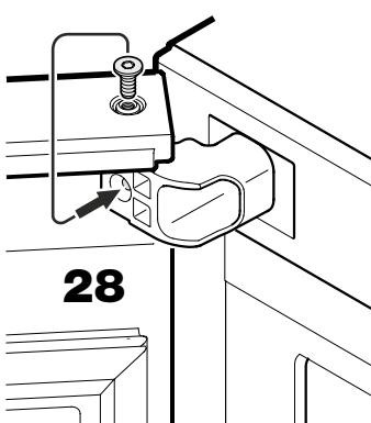
**28.** Выкрутите винт из опорного штифта и закрутите в отверстие шарнирного уголка.
