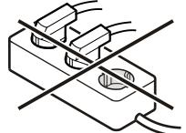
Не используйте автономные инверторы (преобразователи постоянного тока в переменный или трехфазный ток) либо энергосберегающие разъемы. Опасность повреждения электронного оборудования!
