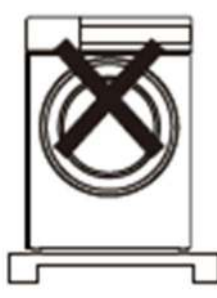
Установка на кронштейн
