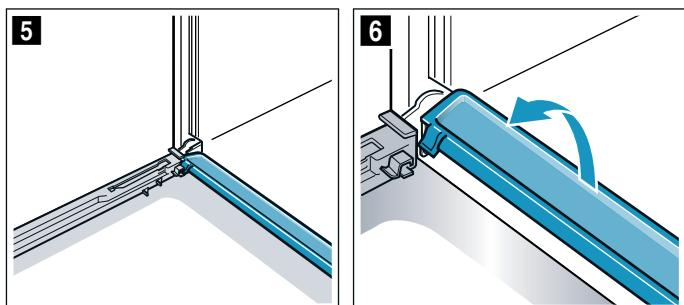
Протрите стёкла мягкой тряпкой, смоченной средством для очистки стёкол. Протрите планку для конденсата тряпкой, смоченной в горячем мыльном растворе.
