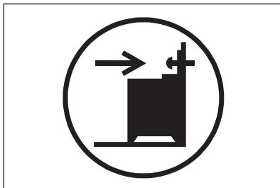
1. Установите защиту от опрокидывания на расстоянии 305 - 310 мм вниз от верхнего края прибора и на 80-85 мм от бокового
