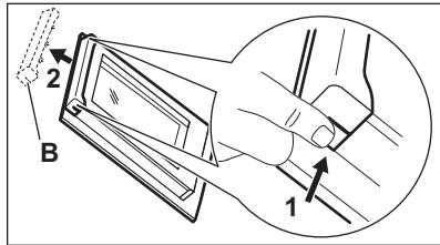
3. Чтобы снять дверную планку, нужно потянуть ее вперед.
