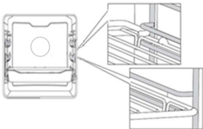
При приготовлении глубокий противень нельзя устанавливать на 1-й уровень, кроме случаев использования глубокого противня для сбора жира и мясного сока при приготовлении на гриле или вертеле.
