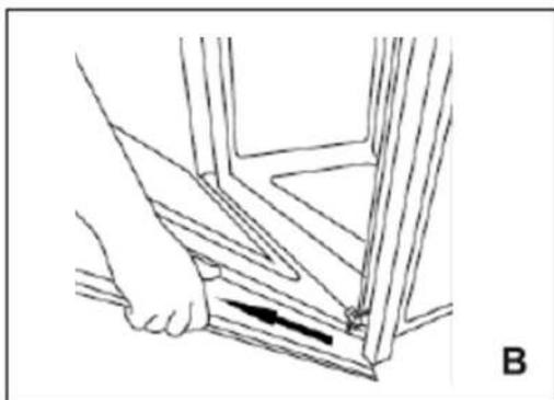
**В** Возьмите дверь обеими руками с двух сторон. Немного поднимите дверь и снимите петли с обеих позиций. Потяните дверь к себе, чтобы снять петли с отверстий рамки двери.
