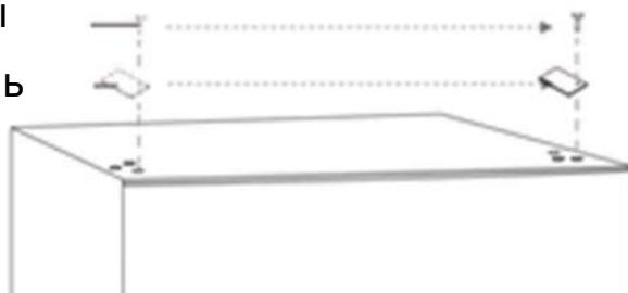
11. Закрепите верхний шарнир в верхней левой части шкафа тремя винтами, которые вы удалили ранее. Перед тем, как затягивать винты верхнего шарнира, убедитесь, что верхняя часть двери находится на одном уровне с корпусом, а резиновая прокладка обеспечивает хорошее уплотнение.
