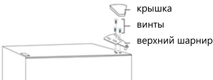
2. Снимите дверь морозильной камеры.
