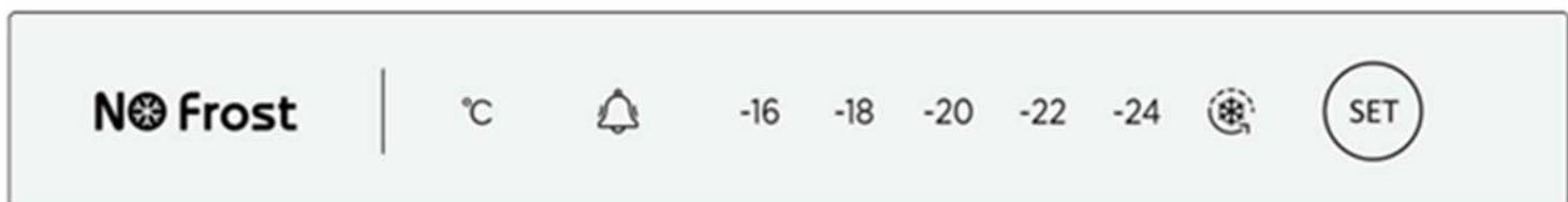
Температура может быть отрегулирована путем нажатия клавиши «**SET**». Каждый раз, когда нажимается клавиша «**SET**», индикатор текущего режима светится, пока загорается индикатор следующего режима. Если в течение 5 секунд не выполняется ни одна из операций с клавишой, указанная настройка режима фиксируется. После того как настройку подтвердили, температура будет немедленно контролироваться в соответствии с настройкой режима.
