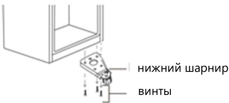
4. Снимите шайбу и гайку, которые крепят вал штифта к правому отверстию на нижнем шарнире, затем снимите вал.
