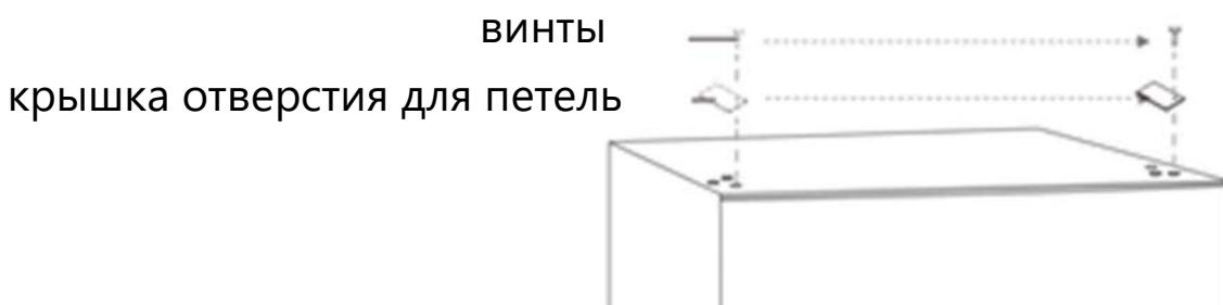
18. Закрепите верхний шарнир в верхней левой части шкафа тремя винтами, которые вы удалили ранее. Перед тем, как затягивать винты верхнего шарнира, убедитесь, что верхняя часть двери находится на одном уровне с корпусом, а резиновая прокладка обеспечивает хорошее уплотнение.
