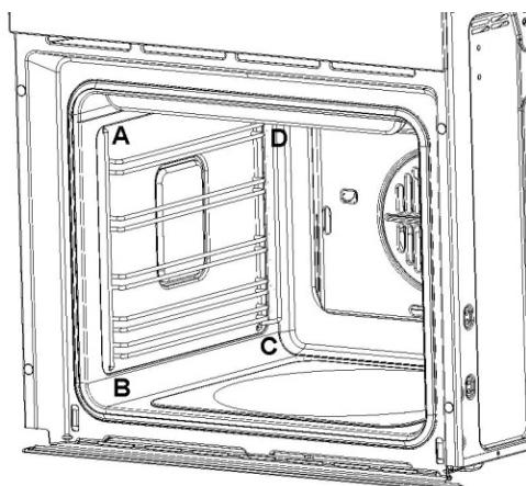
Для того, чтобы снять боковые решетки (как правую, так и левую), совершите следующие действия: бережно потяните и достаньте их из отверстий (A) и (B); повторите то же действие для снятия из отверстий (C) и (D).
