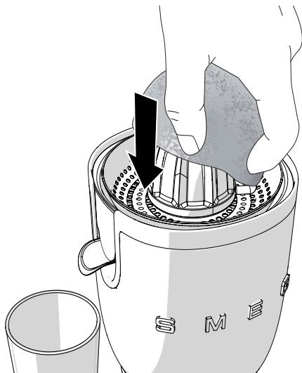
6. После отжима сока снимите корку с конуса для автоматической остановки двигателя и закройте носик (5).
