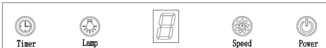
1. Нажмите кнопку «Power», кнопка управляет включением и выключением вытяжки.
