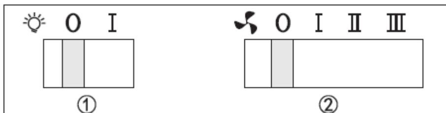
Есть 3 скорости для двигателя и выключатель для лампы.
