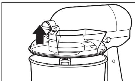
**(НЕ ОБЯЗАТЕЛЬНО)** Снимите защитный обод\*: Снимите переднюю часть защитного обода\* с чаши и потяните ее в направлении от миксера.
