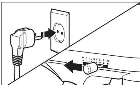
Включите стационарный миксер в заземленную электрическую розетку. Перед началом работы всегда устанавливайте рычаг регулировки частоты вращения на минимальный уровень; во время работы постепенно увеличивайте скорость во избежание разбрызгивания ингредиентов. См. «Руководство для регулировки частоты вращения» для выбора оптимальной скорости.
