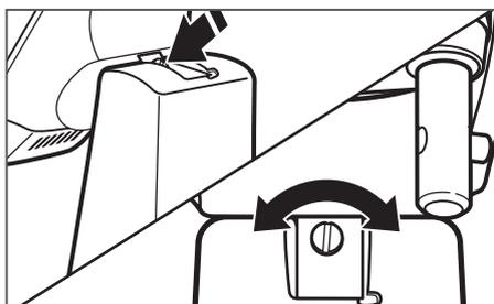
**(НЕ ОБЯЗАТЕЛЬНО) Чтобы отрегулировать расстояние между насадкой и стенками чаши:** Отведите рабочий блок назад, затем слегка поверните винт против часовой стрелки (влево), чтобы поднять насадку, или по часовой стрелке (вправо), чтобы опустить ее. Отрегулируйте насадку так, чтобы она находилась вблизи поверхности чаши. Если вы перекрутите винт, фиксатор чаши может не зафиксировать ее положение.
