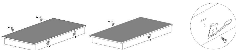
**Монтаж варочной панели:** Установите варочную панель в нише/столешнице, как показано на рисунке ниже. Крепежные скобы с боков надежно зафиксируют варочную панель в нише.
