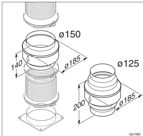
Кроме оснащения воздуховода соответствующей изоляцией, рекомендуется также монтаж данной заслонки, которая улавливает и испаряет образующийся конденсат.
