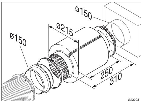
В воздуховод может быть установлен шумоподавитель (дополнительно приобретаемая принадлежность). Он предназначен для дополнительного снижения шума.
