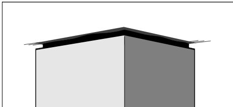
Между коробом вытяжки и потолком можно смонтировать **промежуточную рамку**. Она может использоваться, если необходимо создать оптический эффект промежутка между потолком и коробом (полоска тени). Это может потребоваться, например, если потолок негоризонтальный или неровный. Вытяжка выравнивается в вертикальном положении с помощью прилагаемых выравнивающих деталей. Оптические дефекты между коробом и потолком будут замаскированы полоской тени.
