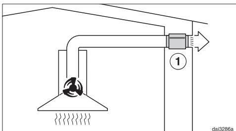
Шумоподавитель уменьшает звук работающего вентилятора, а также внешние шумы, которые могут проникать на кухню через воздуховод (например, шум улицы). Для этого шумоподавитель должен располагаться перед выходным отверстием воздуховода ①, как можно ближе к нему.
