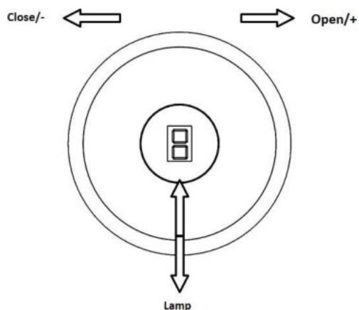
**Control Knob – Ручка управления:** Когда вы вращаете ручку по часовой стрелке; ваше устройство начинает работать, и если вы продолжите вращать, скорость работы увеличивается. Когда вы поворачиваете ручку против часовой стрелки, ваше устройство продолжает сокращать количество циклов и в конечном итоге отключается. Вы можете включить подсветку в зоне приготовления пищи, нажав ручку управления.
