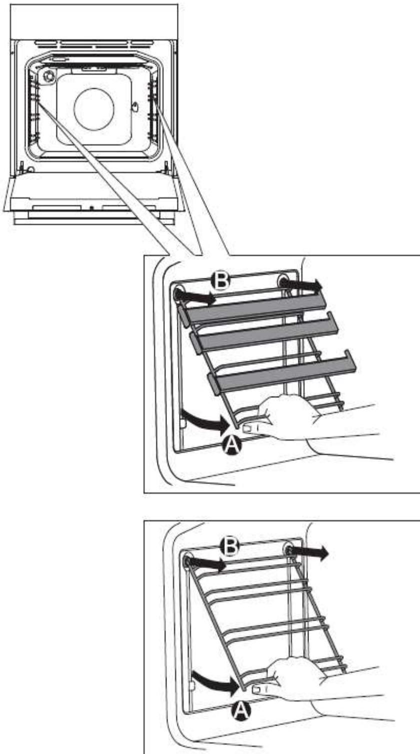
**A** Приподнимите направляющие снизу, отведя их от стенки.
