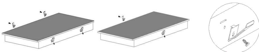
**Монтаж варочной панели:** Установите варочную панель в нише/столешнице, как показано на рисунке ниже. Крепежные скобы с боков надежно зафиксируют варочную панель в нише.
