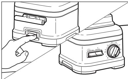
2 Основной выключатель питания находится на задней части основания блендера. Переведите выключатель питания в положение I (Вкл). Световой индикатор состояния над переключателем ▷ II (Пуск/останов) начнет мигать, указывая на то, что блендер находится в режиме ожидания. Теперь блендер готов к работе.
