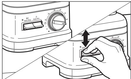
**3** Установите ручку управления на 30 секунд. Переведите переключатель пуска/останова ( $\triangleright/\parallel$ ) вверх или вниз. Когда время выйдет и блендер остановится, слейте мыльную воду и прополосните чашу блендера теплой водой.
