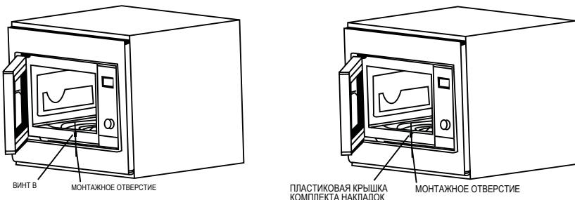
2. Открыть дверцу; закрепить печь в шкафу с помощью ВИНТА В в МОНТАЖНОМ ОТВЕРСТИИ КОМПЛЕКТА НАКЛАДОК. Затем закрепить ПЛАСТИКОВУЮ КРЫШКУ КОМПЛЕКТА НАКЛАДОК в МОНТАЖНОМ ОТВЕРСТИИ
