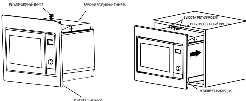
1. Закрепить РЕГУЛИРОВОЧНЫЙ ВИНТ А на ВЕРХНЕМ ВОЗДУШНОМ ТУННЕЛЕ печи, а затем установить печь в шкаф.
