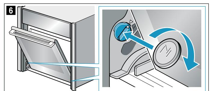
Фиксатор с левой стороны зафиксирован (рис. 7)
