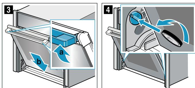
Левый фиксатор: против часовой стрелки
