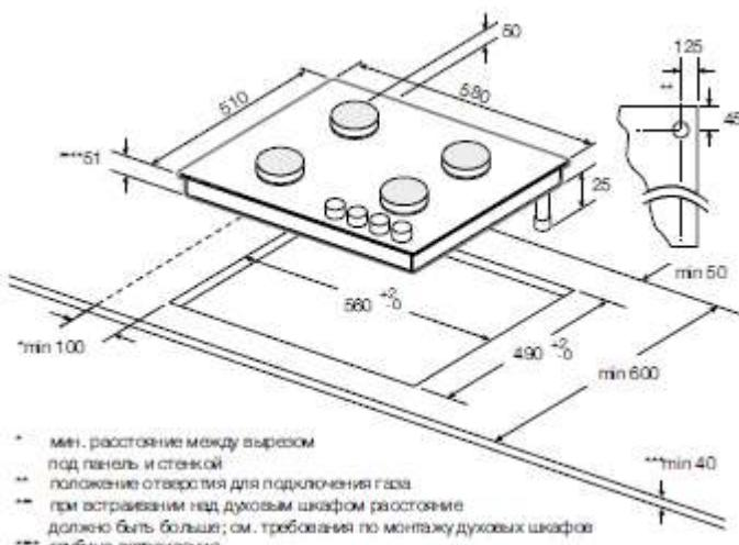
Данная варочная панель предназначена для установки в кухонную мебель с подходящими характеристиками и глубиной до 600 мм.
