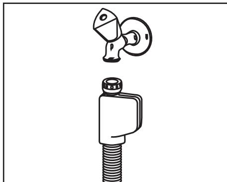
**⚠** Поскольку в комплекте шлангов имеются электрические соединения и компоненты, укорачивание или наращивание шлангов с помощью удлинителей запрещено.
