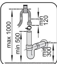
**i** Сливная труба должна быть подсоединенена к системе канализации и не должна отводиться к поверхностным водам.
