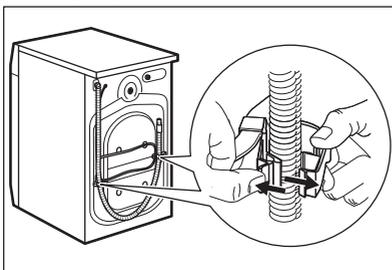
**i** При этом может иметь место вытекание воды из сливного шланга. Это объясняется тем, что прибор проходит тестирование с использованием воды на заводе-изготовителе.
