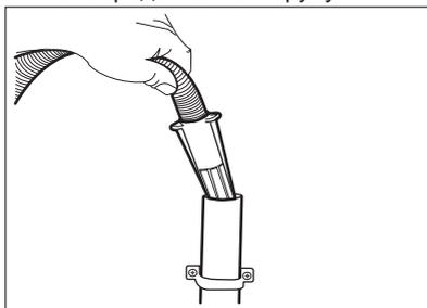
5. **Без помощи пластиковой направляющей для шланга, к сливному отверстию сливной трубы** - Вставьте сливной шланг в сливную трубу и закрепите муфтой. См. Рисунок.
