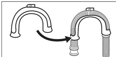
2. Путем установки шланга на край раковины - Привяжите направляющую к водопроводному вентилью или прикрепите ее к стене.
