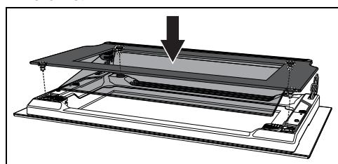
Промежуточный стеклянный блок должен быть установлен на открытой дверце таким образом, чтобы шелкографическая печать в углу читалась слева направо (шероховатая часть шелкографии должна быть обращена к внешнему стеклу дверцы).
