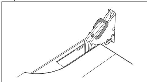
2. Взять дверцу за обе стороны двумя руками рядом с петлями, приподнять ее под углом приблизительно 30° и вынуть.
