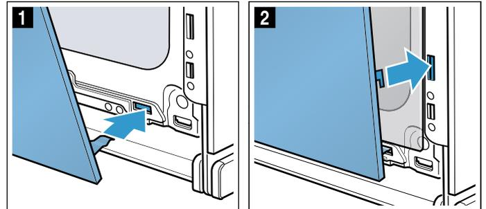
3. Нажмите на переднее стекло так, чтобы оно зафиксировалась со слышимым щелчком (рис. 3).
