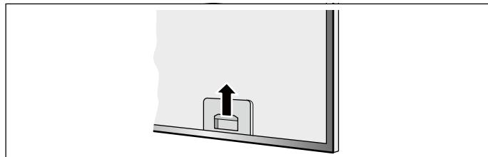
1. Откройте фиксатор металлических жироулавливающих фильтров и извлеките фильтры из крепления,
