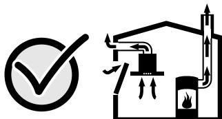
В любой ситуации обращайтесь за советом к компетентному лицу, ответственному за эксплуатацию и очистку труб, способному оценить вентиляционную систему всего дома и предложить Вам решение по принятию соответствующих мер. Если вытяжка работает исключительно в режиме циркуляции воздуха, то эксплуатация возможна без ограничений.
