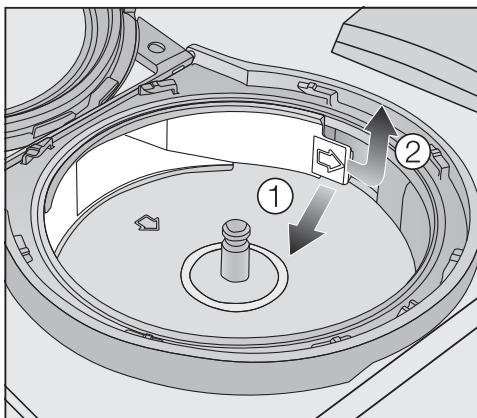
■ Разблокируйте клапан канала дозировки (см. стрелку) ① и вытащите его наружу ②.
