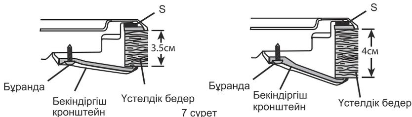
4) Плитаны берілген монтаждау жақшаларымен қажетті орынға қойыңыз. Плитаның төменгі жағындағы алдын ала бұрғыланған тесіктерге кронштейннің бір ұшын бұраңыз. Плитаны қажетті күйде ұстау үшін кронштейннің екінші ұшын үстіңгі тақтайдың астында орналастырыңыз.
