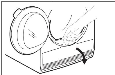
3. Для отпирания крышки конденсатора поверните две блокирующих рычага.
