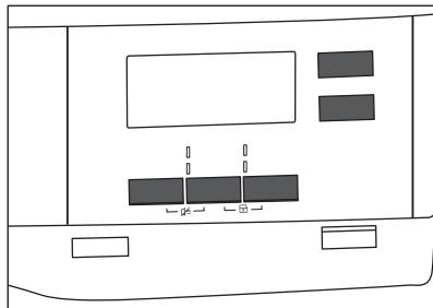
Для включения или выключения опции коснитесь соответствующей кнопки или сочетания из 2 кнопок.
