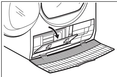
5. Нащупайте ручку и вытяните конденсатор из цокольного отделения. При перемещении держите конденсатор горизонтально, чтобы не пролить оставшуюся в нем воду.
