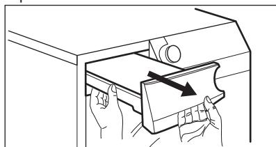
2. Вытяните пластиковый соединитель и слейте содержимое контейнера для сбора конденсата в таз или подходящую емкость.
