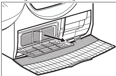
6. Очистите конденсатор, перевернув его в вертикальное положение над раковиной или тазом. Промойте его при помощи душевой насадки.
