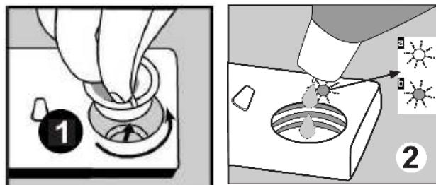
Дозировка ополаскивателя может быть установлена в положение между 1 и 6. Предустановленная изготовителем дозировка – 3. Если после мойки на поверхности посуды остаются пятна от воды, следует увеличить дозировку, в то время как если на поверхности посуды остаётся синее пятно, если по ней провести рукой, следует уменьшить дозировку ополаскивателя (рис. 3).
