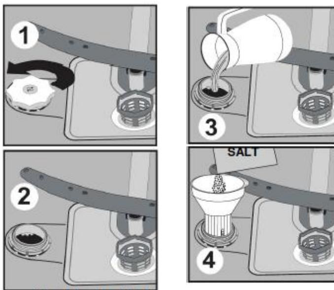
Заливайте воду в контейнер для соли только перед первым рабочим использованием машины.
