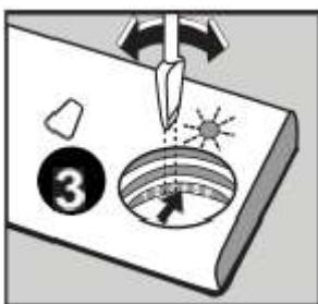
**Внимание:** Используйте только ополаскиватели, специально предназначенные для посудомоечных машин. Поскольку излишек ополаскивателя, образующийся в результате переполнения кюветы, приводит к образованию очень большого количества пены, что снижает эффективность работы машины, следует удалить указанный излишек ополаскивателя с помощью ткани.
