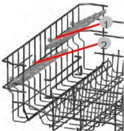
Вышеуказанные полки предназначены для увеличения вместимости верхнего короба. На них можно разместить стаканы и чашки. Вы можете регулировать эти полки по высоте. Благодаря этой функции, на полках можно размещать стаканы различного размера.
