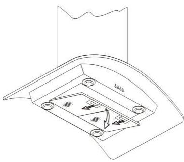
Замена фильтров и сеток Кухонная вытяжка может быть снабжена фильтром алюминиевым. Фильтр фиксируется пружинным замком.
