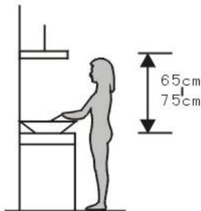
Вытяжка предназначена для выведения запахов и паров из кухонного помещения. Воздух надо отвести наружу непосредственно в атмосферу или через вентиляционные каналы (за исключением высотных домов).
