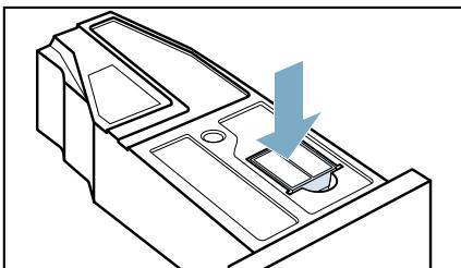
12. Задвиньте резервуар для конденсата до фиксации.
