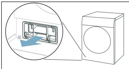
8. Протрите отверстие в приборе мягкой влажной тряпкой.
