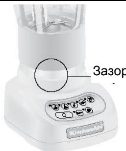
Кувшин неправильно установлен на фиксирующем кольце, и муфты не зацепляются. Снимите кувшин с основания и плотно вставьте в кольцо. Нажмите на кувшин вниз и поверните по часовой стрелке до положения фиксации с двумя щелчками. В этом положении муфты зацепляются. См. раздел "Сборка блендера".
