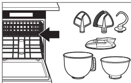
2 Чашу, защитный обод\*, белую лопатку для смешивания, Лопатка с гибким ребром\* и белую насадку для теста можно мыть в посудомоечной машине. Кроме того их можно тщательно промыть в горячей мыльной воде и полностью ополоснуть перед сушкой. Венчики не следует хранить на валу.
