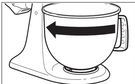
**3** Установите чашу в фиксатор. Осторожно поверните чашу в направлении часовой стрелки.
