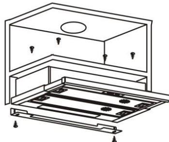
Вытяжка предназначена для выведения запахов и паров из кухонного помещения. Воздух надо отвести наружу непосредственно в атмосферу или через вентиляционные каналы (за исключением высотных домов). В вытяжке установлена одна лампочка мощностью в 40 Вт. Не надо употреблять лампочки мощностью выше 60 Вт, потому что это может привести к перегреву элементов вытяжки.
