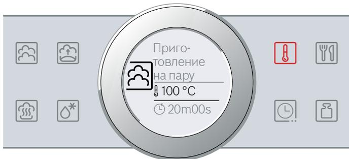
2. Установите температуру с помощью поворотного регулятора.
