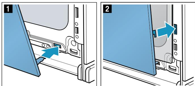
3. Нажмите на переднее стекло так, чтобы оно зафиксировалось со слышимым щелчком (рис. 3).
