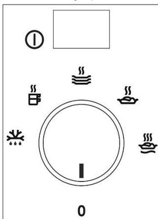
На панели управления расположен переключатель режимов и двухпозиционный выключатель Вкл/Выкл. Панель управления видно только в открытом положении выдвижного ящика.
