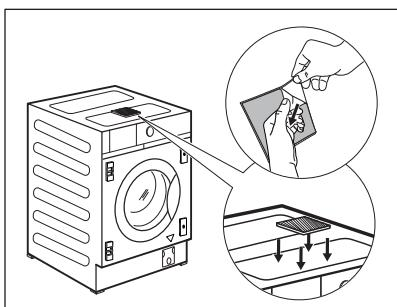
Прибор также снабжен клейкой пористой накладкой **H**, которая находится внутри барабана.
