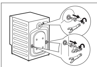
6. Извлеките три болта, держатели шлангов и пластиковые вставки с помощью ключа, входящего в комплект поставки прибора.
