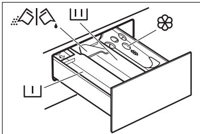
**[[ ]]** - Отделение для моющего средства, используемого на этапе предварительной стирки, замачивания или выведения пятен.
