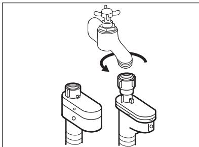
5. Присоедините напливной шланг к водопроводному крану холодной воды с резьбой 3/4 дюйма.
