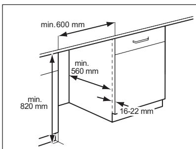
Данный прибор рассчитан на встраивание в кухонную мебель. Размеры ниши для встраивания прибора указаны на данном рисунке.
