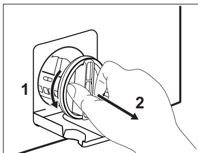
6. Чтобы снять фильтр, поверните его против часовой стрелки
