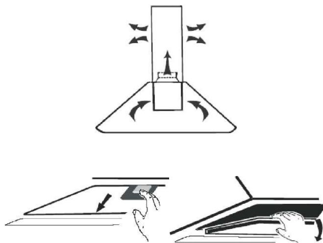
Угольный фильтр поместите на мотор вытяжки (с двух сторон – в зависимости от конструкции) и поверните его по часовой стрелке.
