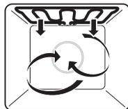
Воздух в камере прогревается нагревательным элементом, расположенным за задней стенкой камеры, и равномерно циркулирует.
