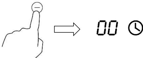
5. После установки значения таймера сразу же начнется обратный отсчет. На дисплее будет отображаться оставшееся время, а индикатор таймера будет мигать в течение 5 секунд.
