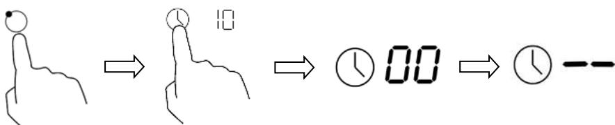
6. По истечении установленного времени соответствующая варочная зона отключится автоматически. Раздается однократный звуковой сигнал, на индикаторе таймера отобразится "--".
