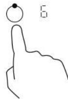
2. Выключите варочную зону, нажимая “-”, пока не отобразится “0”. Убедитесь, что на дисплее мощности отображается “0”, а затем “Н”.
