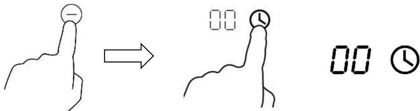
5. После установки значения таймера сразу же начнется обратный отсчет. На дисплее будет отображаться оставшееся время, а индикатор таймера будет мигать в течение 5 секунд.
