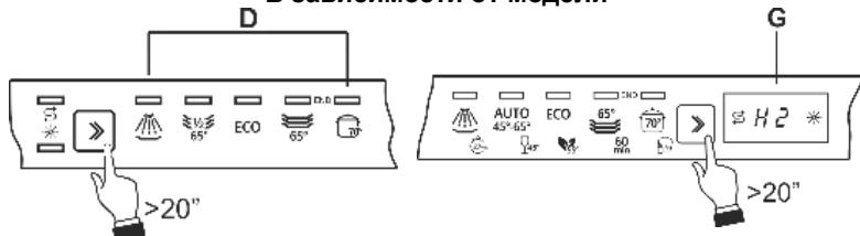
Если после выполнения регулировки или просмотра заданного значения не касаться кнопки в течение нескольких секунд, посудомоечная машина автоматически выйдет из режима регулировки и вернется в стандартный режим работы.
