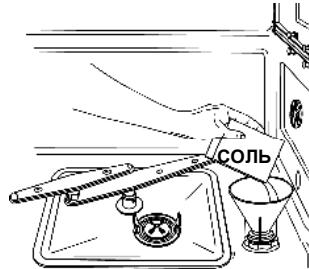
При средней жесткости воды обновляйте соль примерно после 20 **циклов мойки**. Емкость умягчителя рассчитана примерно на **1 кг соли** в гранулах. Некоторые модели оснащены оптическим индикатором отсутствия соли. На крышке емкости для соли у этих моделей расположен зеленый поплавок, который опускается по мере уменьшения количества соли. Когда зеленый поплавок пропадает, это значит, что необходимо добавить соль. Емкость для соли расположена внизу посудомоечной машины.
