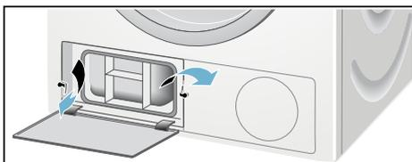
11. Закройте дверцу для технического обслуживания и прижмите её до ощутимой фиксации.
