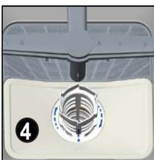
Очистите крупный фильтр. Вставьте крупный фильтр в микрофильтр в соответствии с метками на них. Вставьте микрофильтр в металлический/пластмассовый фильтр и поверните его в соответствии с направлением стрелки. Конструкция
