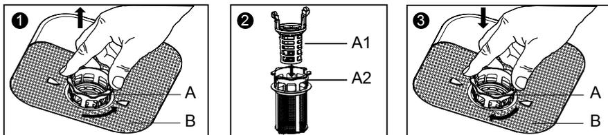
1. Поверните фильтр A против часовой стрелке и снимите его, снимите фильтр B.
