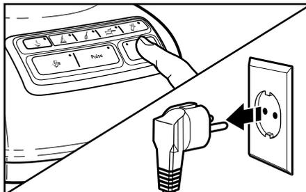
**3** Чтобы остановить работающий блендер, нажмите кнопку ВКЛ. (POWER) (⏻), а для отключения прибора нажмите кнопку ВКЛ. (POWER) (⏻) повторно. Перед снятием кувшина отключите блендер от сети.
