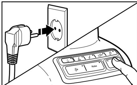
**5** Перед тем как включать блендер, подсоедините его к заземленной розетке и нажмите кнопку ВКЛ. (POWER) (⏻). Мигающий индикатор ВКЛ. означает готовность прибор к работе.
