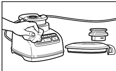
**1 Для чистки основания, панели управления, шнура, крышки и мерного стакана:** Перед чисткой отключите блендер от сети. Протрите ткань, смоченной в теплой воде, затем влажной тканью и вытрите сухой мягкой тканью.
