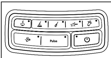
Блендер имеет четыре скорости: ИЗМЕЛЬЧЕНИЕ (🔪), СМЕШИВАНИЕ (🌀), ПЮРЕ (🍴) и СЖИЖЕНИЕ (🥛). У него также есть 3 специальные функции: ГОРЯЧИЕ ПРОДУКТЫ (🔥) КОЛКА ЛЬДА (🧊) и ИМПУЛЬСНЫЙ (Pulse) режим.
