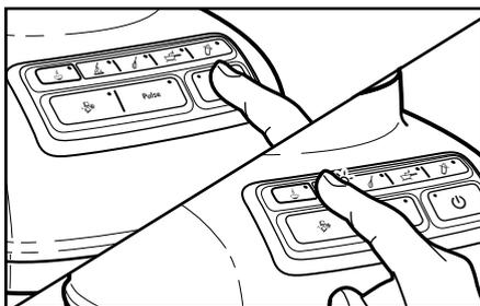
**4** Нажмите и удерживайте кнопку скорости в течение необходимого времени. При работе в импульсном режиме индикаторы импульсного режима и выбранной скорости будут светиться постоянно. Если отпустить кнопку импульсного режима, перемешивание остановится и начнет мигать индикатор импульсного режима. Для дальнейшей работы в импульсном режиме снова нажмите и удерживайте кнопку выбранной скорости.
