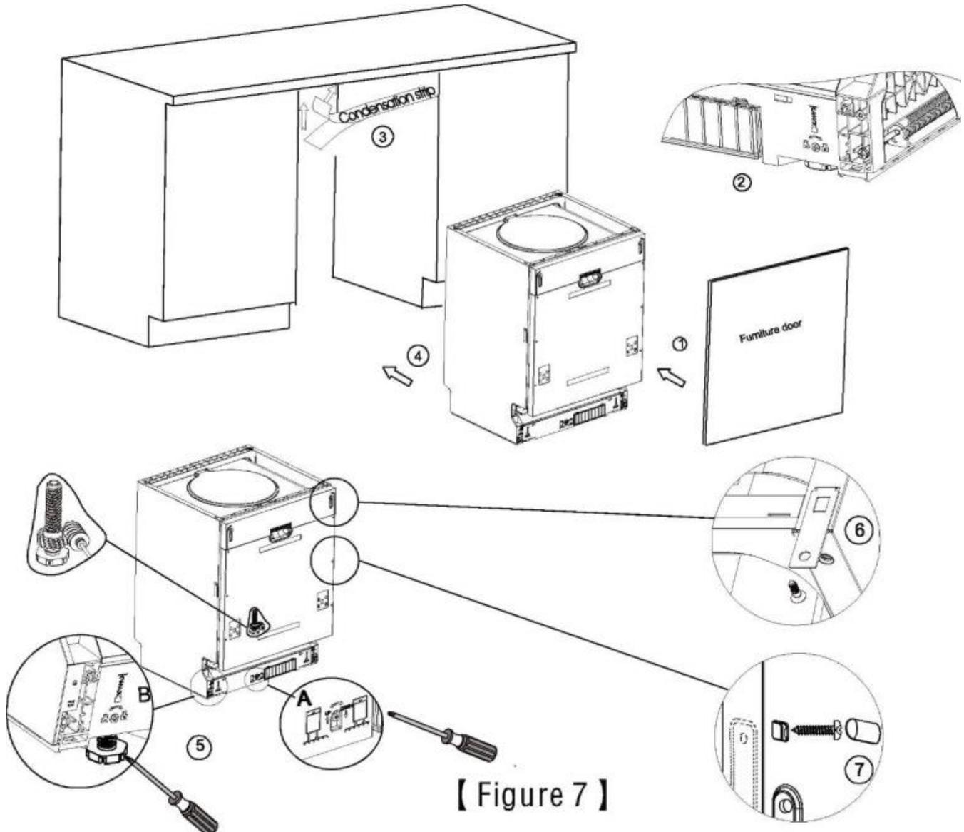
Положите на дверцу машины и внутрь кюветы уровень, чтобы проверить, ровно ли расположена машина. Выровняйте машину, регулируя каждую опорную ножку отдельно. Выравнивая положение машины, старайтесь не опрокинуть ее.
