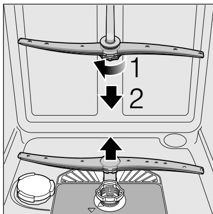
4. Промойте распылительные коромысла в проточной воде.
