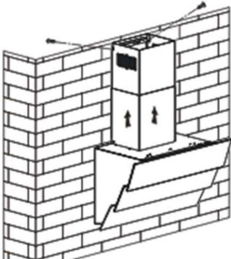
8. Выдвиньте внутреннюю часть короба на высоту саморезов, подвесьте короб на саморезы за фиксирующую скобу. По отверстиям скобы отметить и просверлить 2 отверстия диаметром 8 мм и глубиной 75~85 мм. Далее следует выровнять фиксирующую скобу с отверстиями и затянуть саморезами 5x60.
