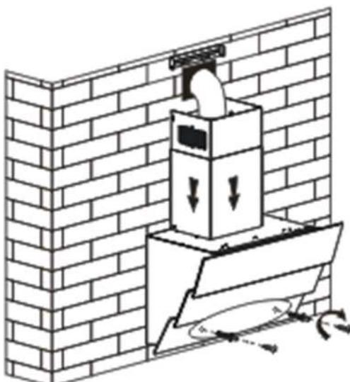
7. Подвесьте вытяжку на саморезы, выровняйте её по горизонту и затяните саморезы отверткой.
