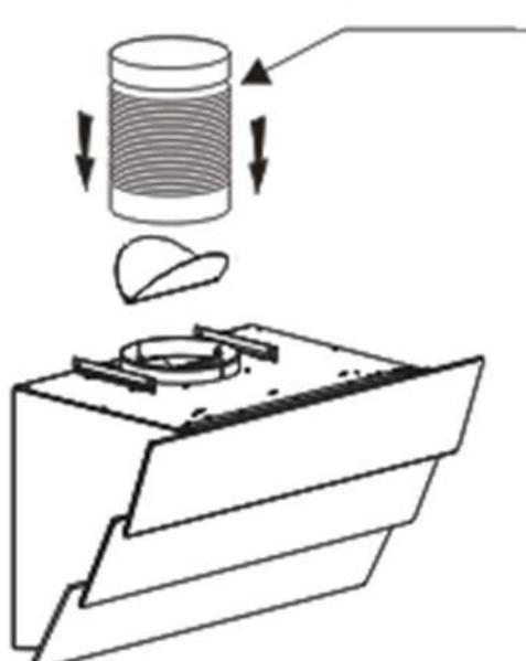
3. Извлеките вытяжку из коробки и аккуратно поставьте на горизонтальный рабочий стол. Установите выходную трубу 120 мм к выходному патрубку и убедитесь, что она плотно присоединена.
